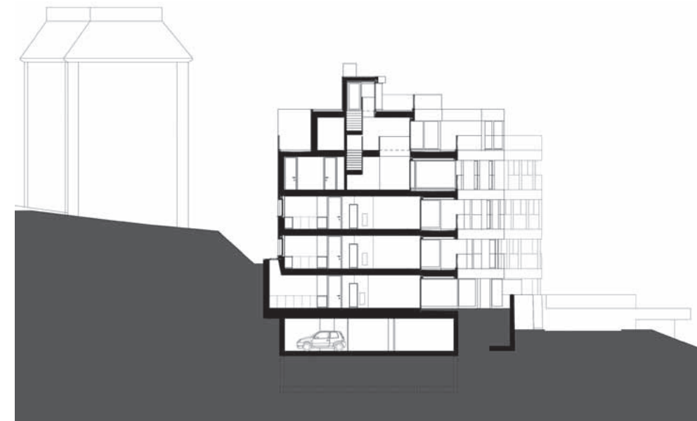
Der Schnitt zeigt die schwierigen topografischen Verhältnisse, auf die der Baukörper reagieren muss.
